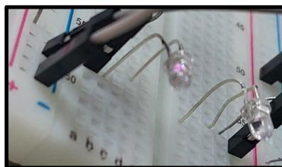
Figura 2 - Emissor de luz infravermelha
