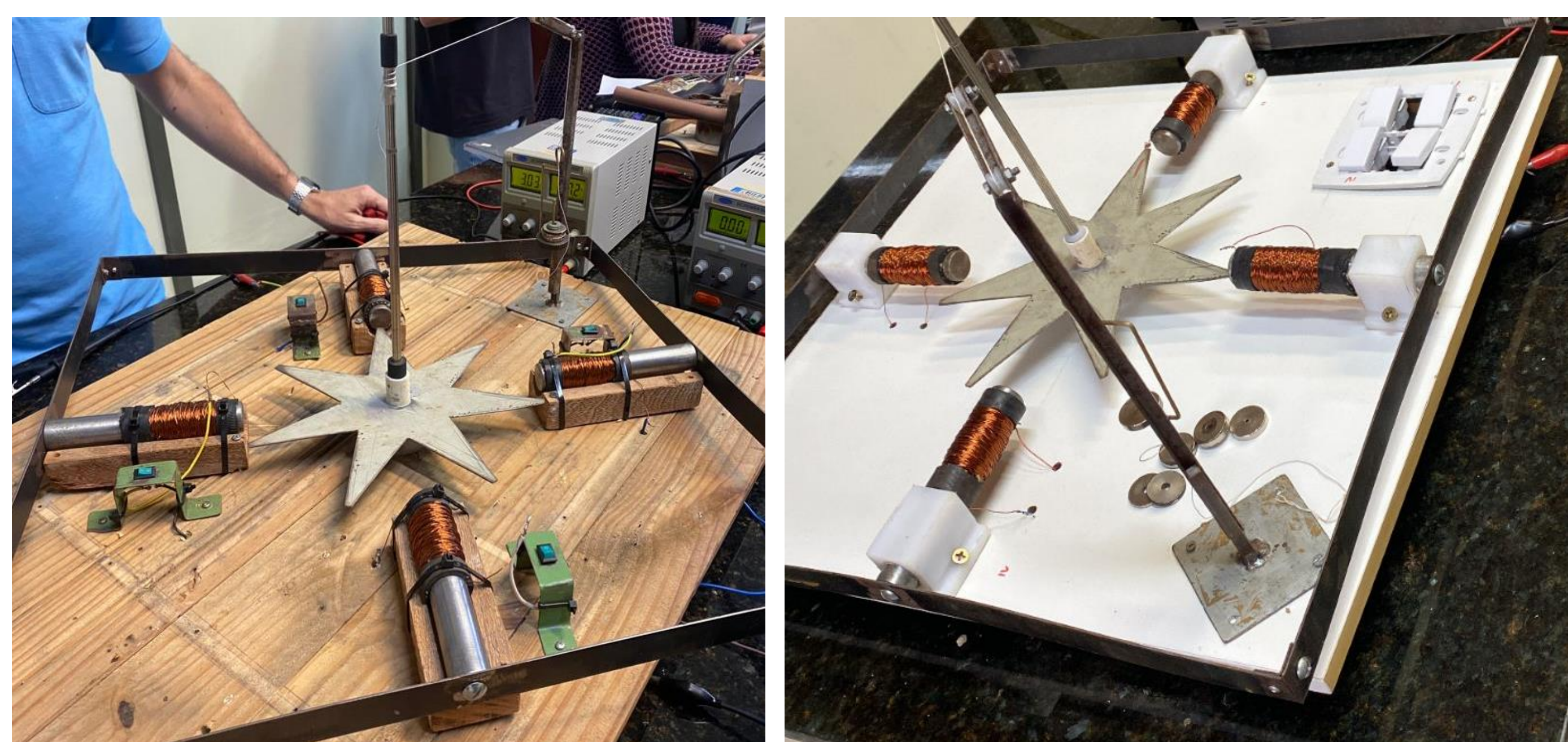
Figura 2 – Motor de Passo de Relutância Variável Versão 1.0 Figura 3 – Motor de Passo de Relutância Variável Versão 2.0
